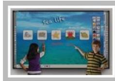
Dank der Zehnfachbenutzer-Eingabe können bis zu zehn Anwender gleichzeitig auf der gesamten StarBoard Oberfläche schreiben und arbeiten.
